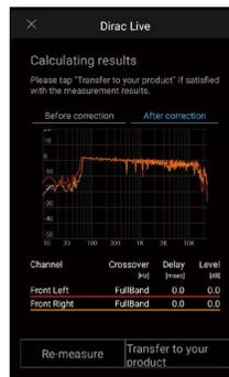
9. Trennen Sie das Messmikrofon zur Lautsprechereinrichtung ab. Die auf den Messergebnissen beruhenden Lautsprecheranpassungen werden auf dem Gerät gespeichert. Sie können 3 Muster der Filterkurven aus den Messergebnissen ändern und in 3 Slots speichern (→[p172](#)). Die gespeicherten Filterkurven können mit "Room EQ" - "Dirac Live" (→[p93](#)) im Quick-Menü ausgewählt werden.
